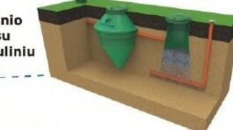
NV tipo įrenginio montavimas su kauburine infiltracija esant aukštiems grunitiniams vandenims
